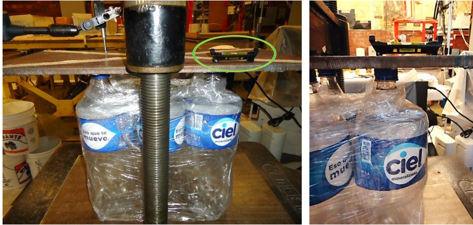
Figura 4.7 Prueba con comportamiento óptimo. En la imagen de la derecha se observa el nivel marcando la horizontalidad de la placa después de haber fallado los envases
