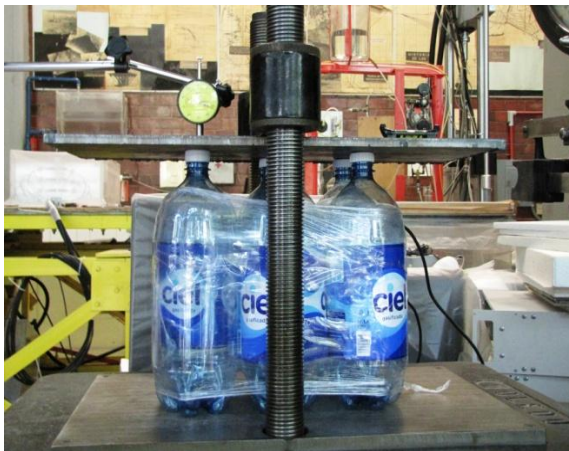
Ensayos en la Máquina Toledo a conjuntos de envases
