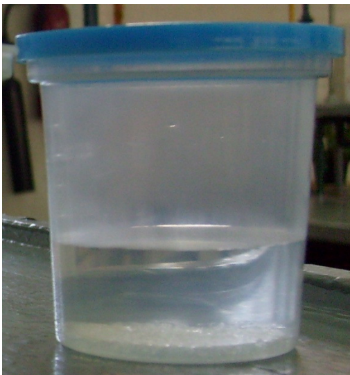
Figura 3.4. Solución de bisulfato de potasio para la lixiviación sin agitación, preparada con 2.922 g de sulfato ácido de potasio ( \text{KHSO}_4 ) y aforando con agua destilada en un matraz de 50 ml.
