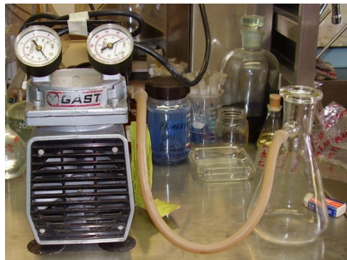
Figura 3.8. Bomba de vacío para filtrar las soluciones de cobre sin permitir el paso del mineral de ganga.
