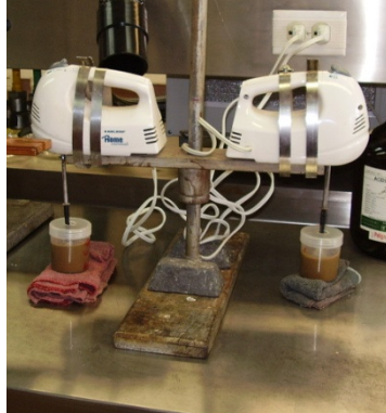
Figura 3.7. Batidoras Black & Decker de tres velocidades para realizar la agitación de la pulpa mineral: 900, 950 y 1000 RPM.
