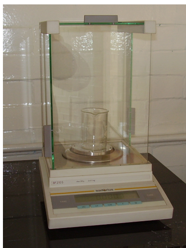
Figura 3.5. Balanza analítica Sartorius BP 210 S con un vaso de precipitados de 100 ml.
