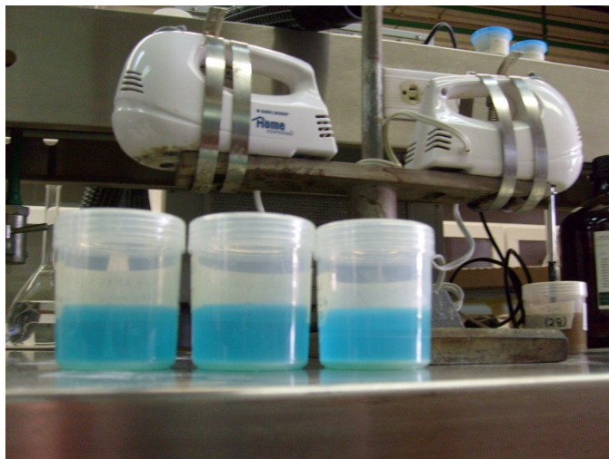
Figura 3.2. Lixiviación con agitación (dinámica) del mineral oxidado de cobre.
