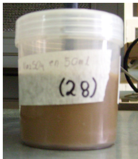
Figura 3.1. Pulpa del material 1 durante la agitación, preparada con la solución acuosa del sulfato ácido de potasio.
