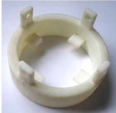
Figura 4.15 Prototipo rápido de la parte exterior de la interfaz del sistema de suspensión con el socket
