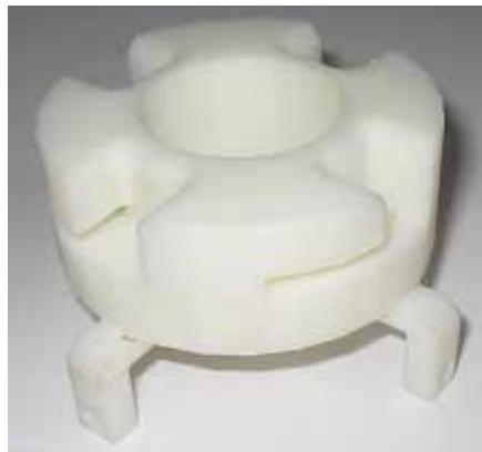
Figura 4.16 Prototipo rápido de la parte interior de la interfaz del sistema de suspensión con el socket
