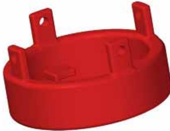
Figura 4.9 Primera configuración de la parte exterior de la interfaz del sistema de suspensión con el socket
