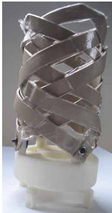
Figura 5.12 Sistema de suspensión unido con la interfaz entre él y el socket
