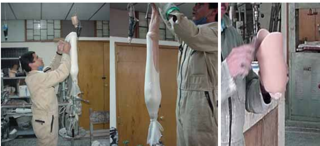
Figura 1.16 Fabricación de un socket por el método artesanal
