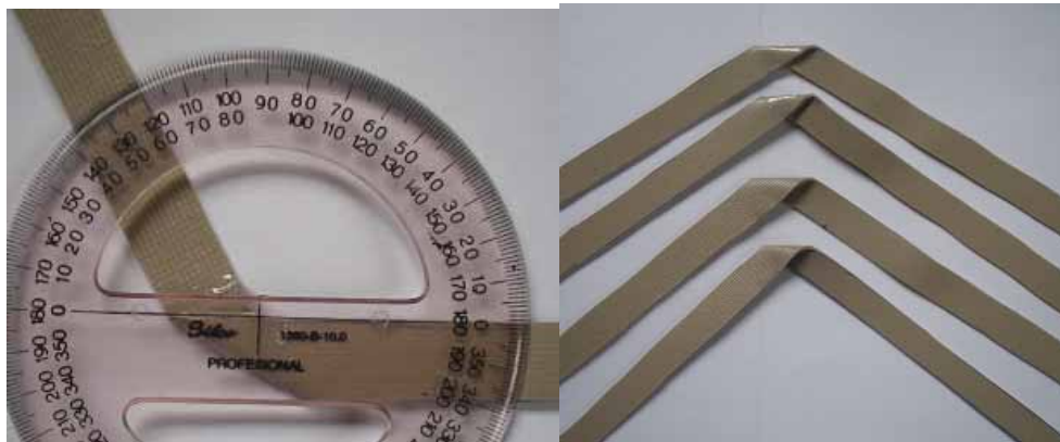
Figura 5.2 Dobles a 120° en cada hilo de la malla
