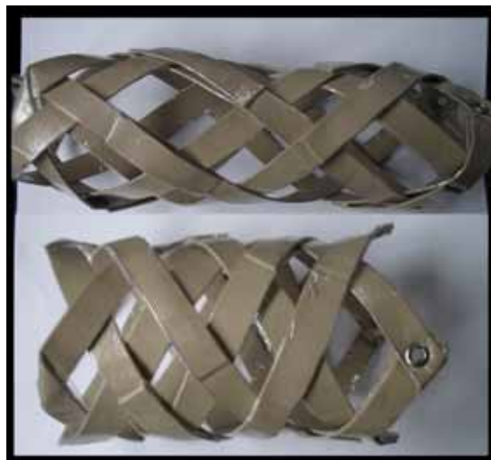
Figura 4.2 Cambio de diámetro de la malla
