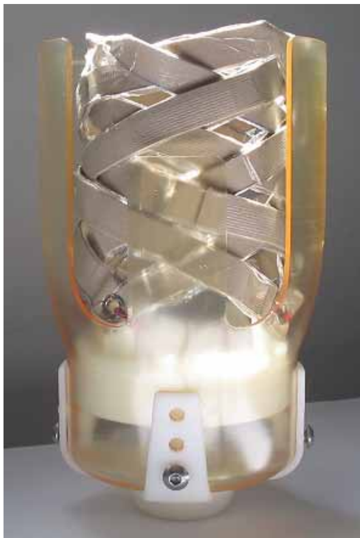
Figura 5.16 Ensamble del Socket de miembro superior a nivel transhumeral
