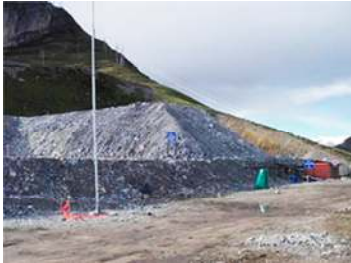
Figura 17: Prueba de campo en pilas con dimensiones de 36x36x10m (alto) en mina peruana.
