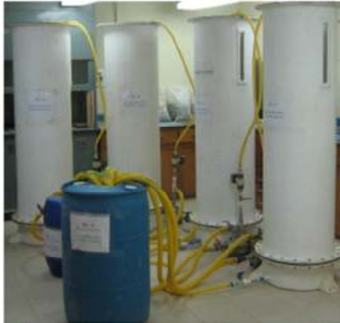
Figura 12: Prueba de Lixiviación en columnas, con dimensiones visiblemente mayores a las usuales.
