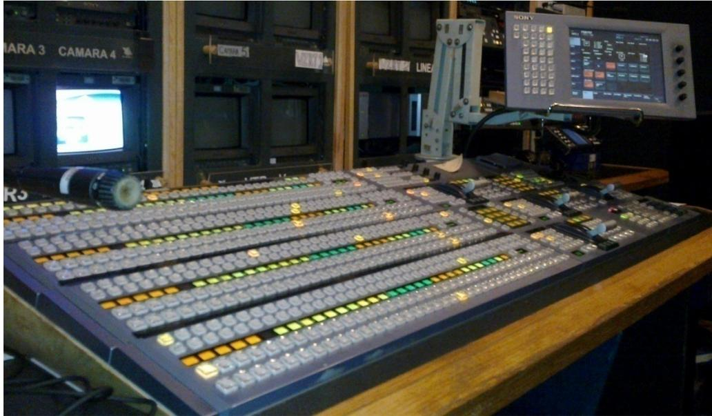
Figura 4-1 Mezclador de vídeo o Switcher Sony DVS-8000
