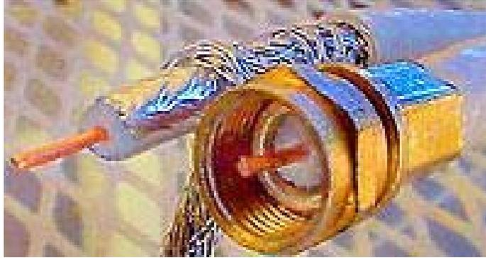
**Figura 3.1-29 Vista en corte de la parte interior de alambre de cobre y estándar de conector coaxial.**
