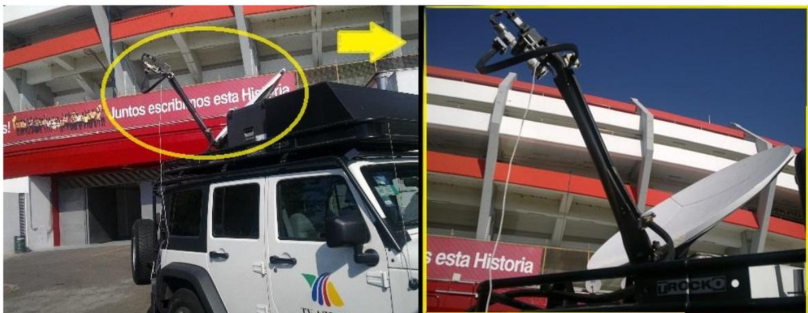
Figura 5-2 Antena en banda Ku para la transmisión de fútbol
