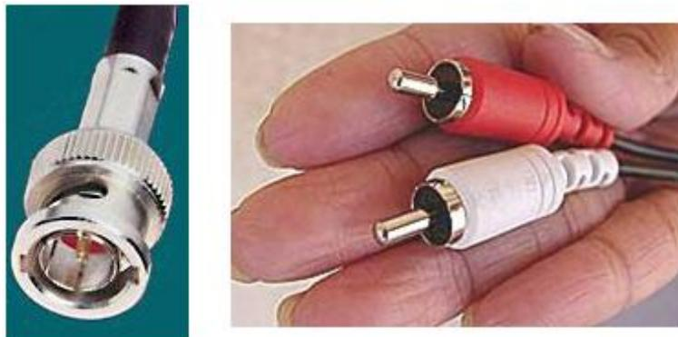
**Figura 3.1-30 Conector de vídeo BNC y Conector RCA (audio y vídeo)**
