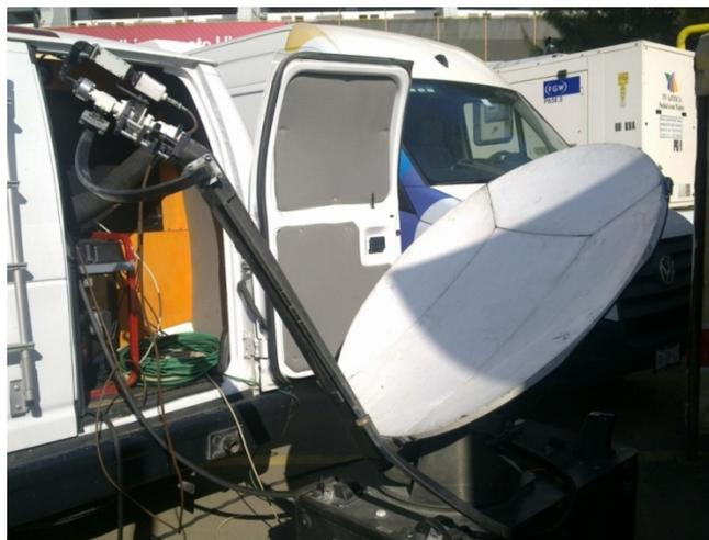
**Figura 3.1-26 Antena para la transmisión en banda Ku**
