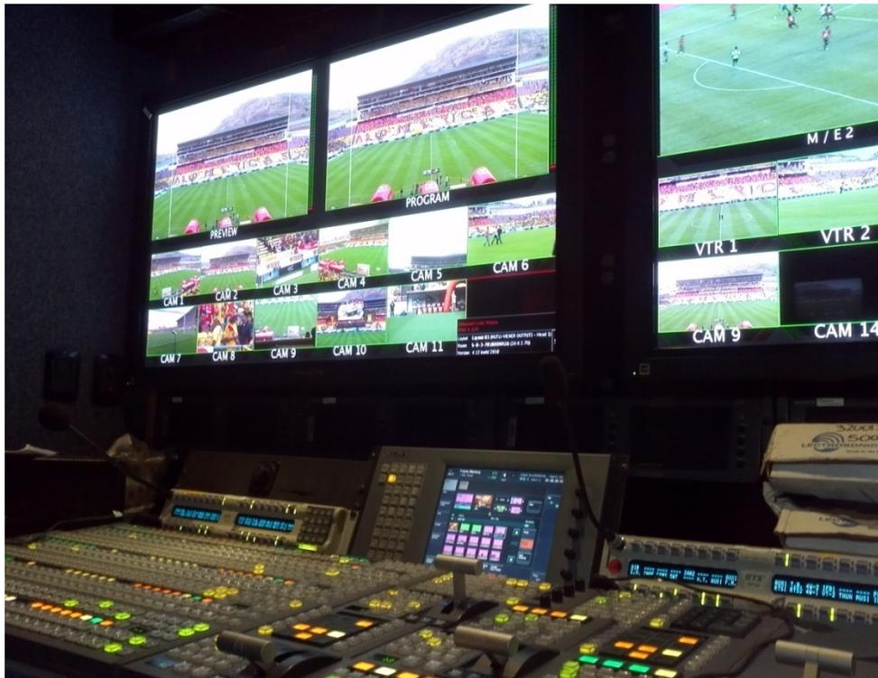
**Figura 6-1 Switcher Sony 8000 y monitoreo de las señales de vídeo en formato HD dentro de una unidad móvil para un partido de fútbol nacional**
