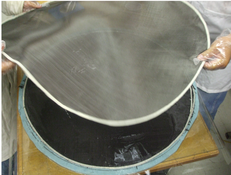
Figura 2.3 Plataforma construida con fibras de carbono.
