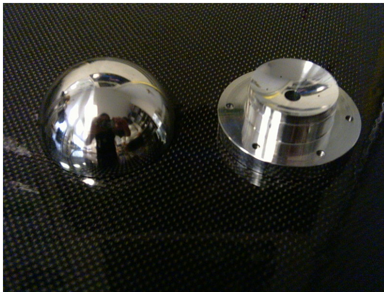
Figura 3.1. Semiesfera y copa, las dos piezas principales de un cojinete neumático esférico.
