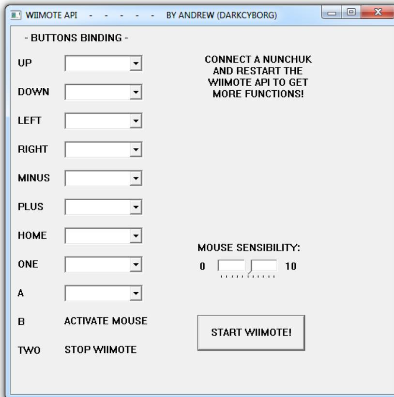
El conjunto de objetos “combobox” del lado izquierdo permite asignar una función a cada botón del Wiimote, ya sea de ratón o de teclado. Los dos últimos botones se indican solamente para que el usuario reconozca las opciones de activación del puntero y de detener el muestreo del Wiimote.
