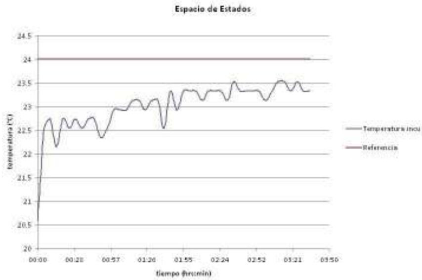
Figura 6.6: Gráfica de la temperatura en la incubadora utilizando control en el espacio de estados.
