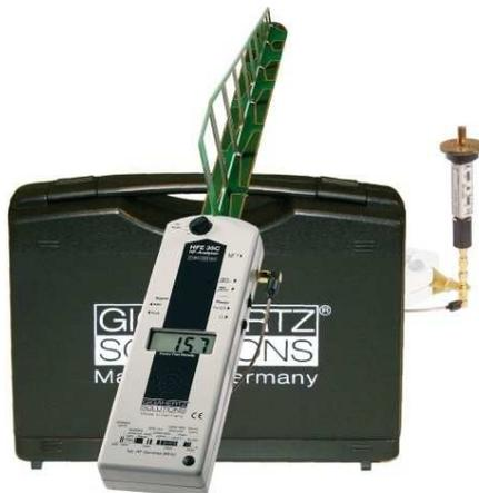
**Imagen 76. Medidor HFE35C. Fuente: <http://www.electrocontaminación.net>
