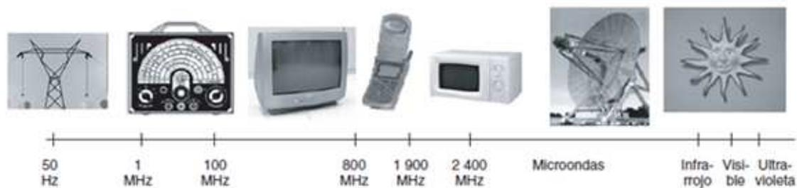
**Imagen 13. Espectro electromagnético de las radiaciones no ionizantes.**
