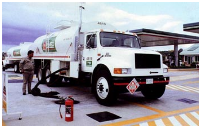
Figura 1.25 Distribución de gasolina en la estación de servicio Fuente: Revista octanaje No. 29 (Pemex, 2001)
