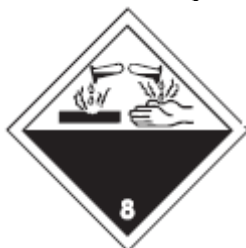
Figura 1.17 Identificación para el transporte de corrosivos clase 8 Fuente: Guía de respuesta en caso de emergencia (US DOT, 2004)
