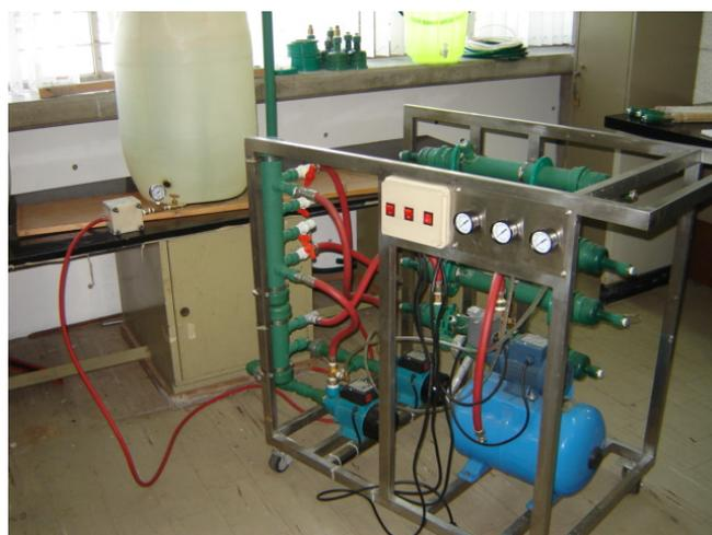
*Figura 3.1. Unidad de laboratorio para ultrafiltración*
