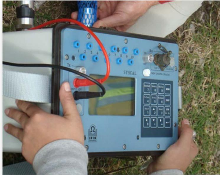
Figura 5.3 Fotografía del equipo SYSICAL Pro.
