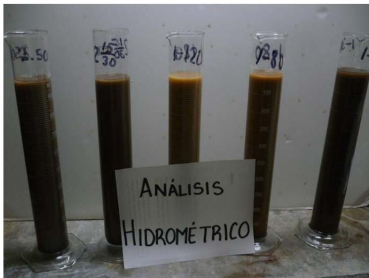
Figura 7 Mezclas del análisis hidrométrico
