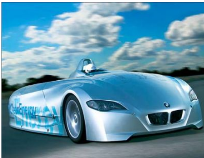
Figura 8.4 BMW operando con H 2 como combustible
