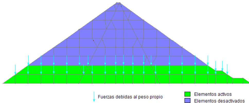
Figura 6.6. Activación de elementos y aplicación de fuerzas por peso propio para el análisis de la etapa 2.
