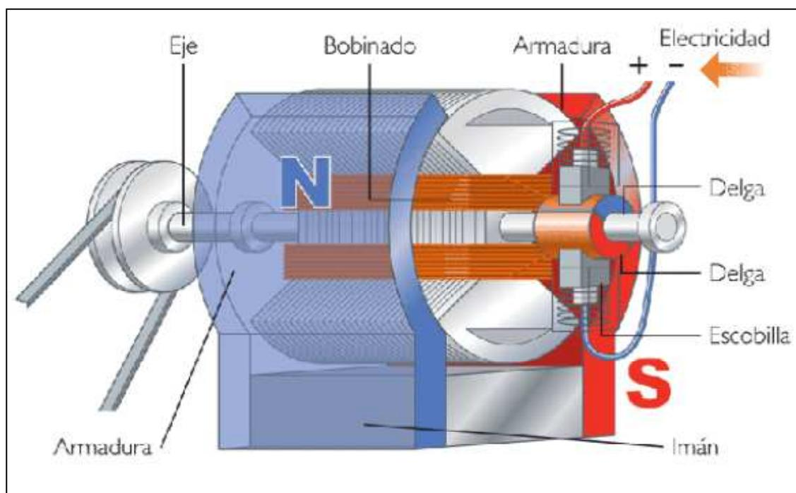
**Figura 1.6 Principio de funcionamiento de motores eléctricos** (Tecnoficio, 1998).
