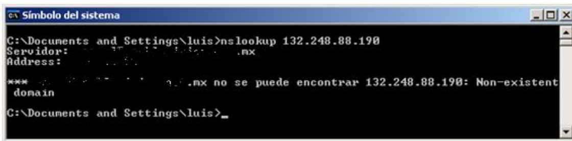
Imagen 49: Búsqueda del servidor mediante nslookup de la dirección 132.248.88.190
