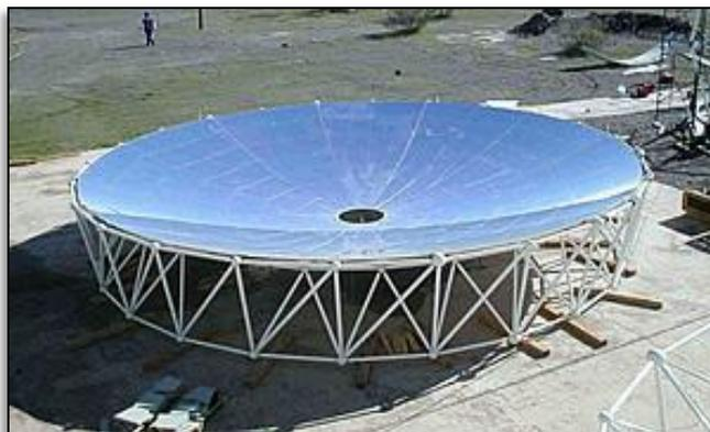
Figura 3.14: Concentrador solar Disco Parabólico.
