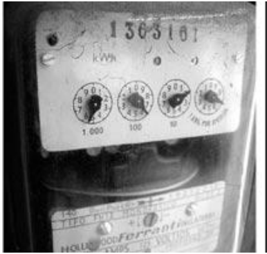
Figura 3-16 Medidor electromecánico de consumo eléctrico
