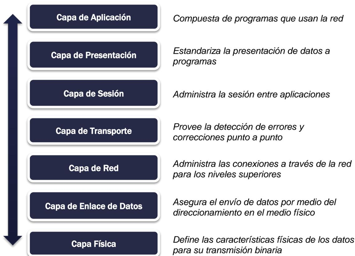
Figura 3.17 - Capas Modelo OSI
