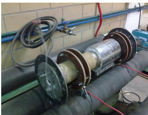
Imagen 15. Salida de Trióxido de Antimonio por un extremo sin el conducto de salida.
