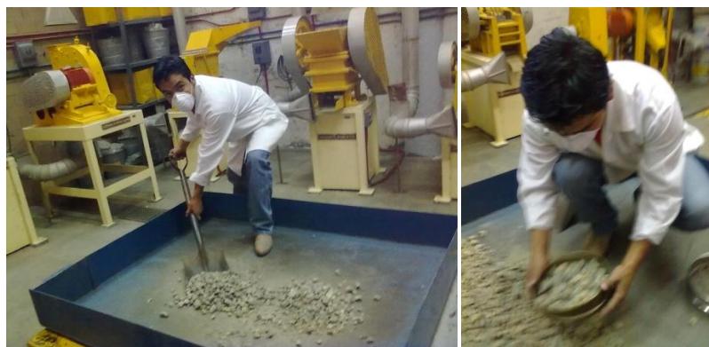
Imagen 12. Muestreo y cuarteo del mineral en el Laboratorio de Metalurgia de la Facultad de Ingeniería
