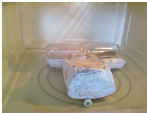
Imagen 20. Mineral dentro del tubo de cuarzo.
