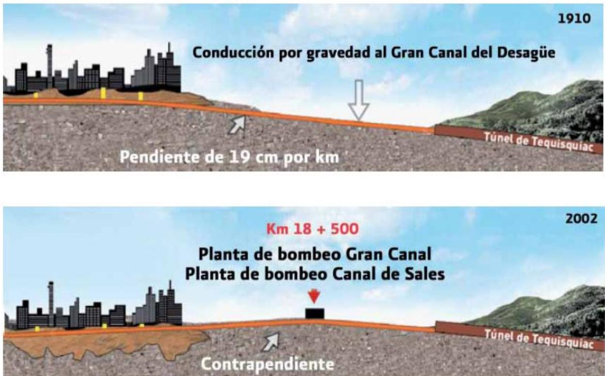
Figura 1 Conducción y pendientes para el desalojo de aguas residuales.
