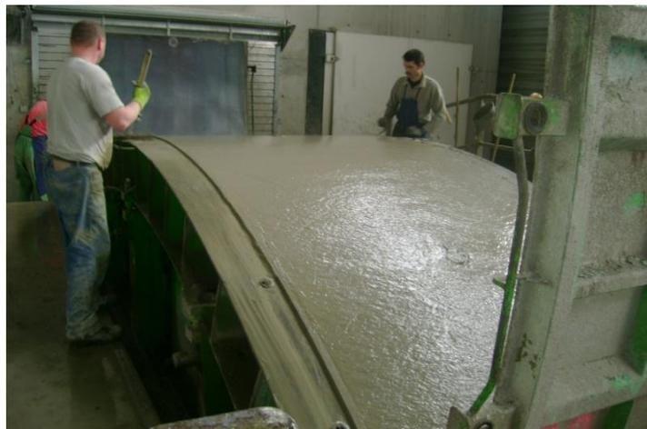
Figura 3.2.2 Fabricación de dovelas
