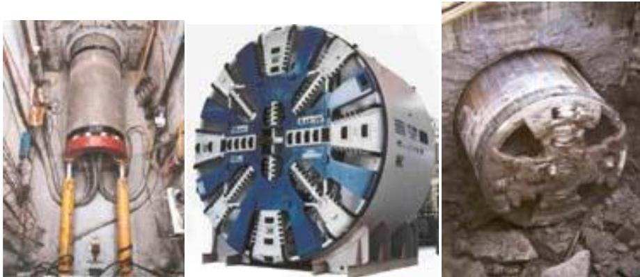
Debido a las particularidades de proyecto de cada túnel, tales como la geología, diámetro y longitud, cada uno necesita una máquina distinta. Aun así, la tecnología que domina el mercado se puede clasificar, en términos generales, en dos tipos:
