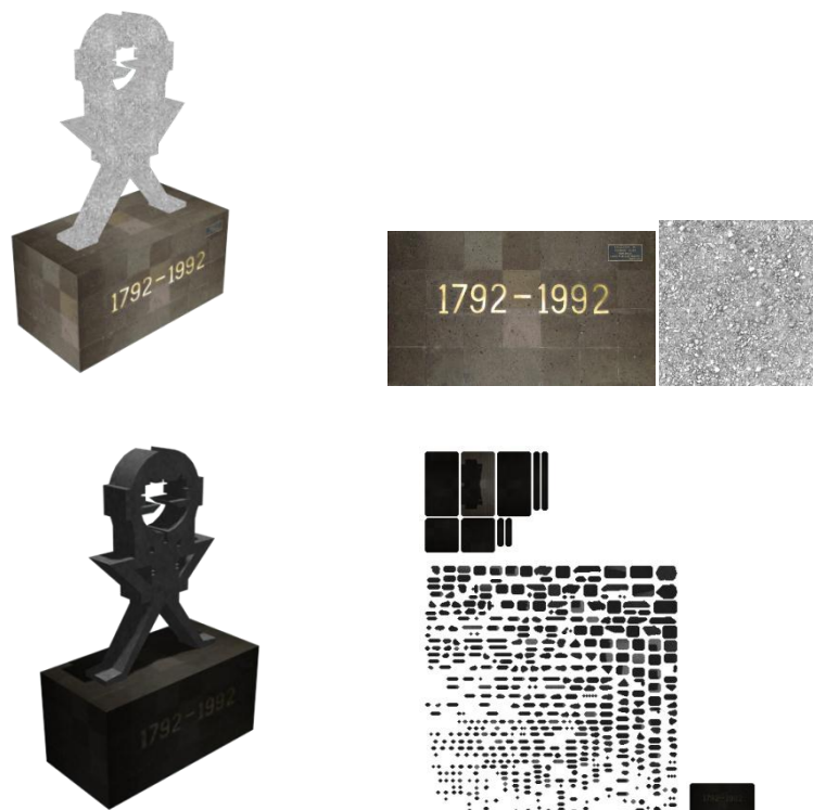
Figura 69 Mapeado UVW original (arriba) y generado por el modelador (abajo)
