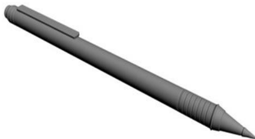
Figura 13 Modelo 3d de una pluma generada a partir de splines
