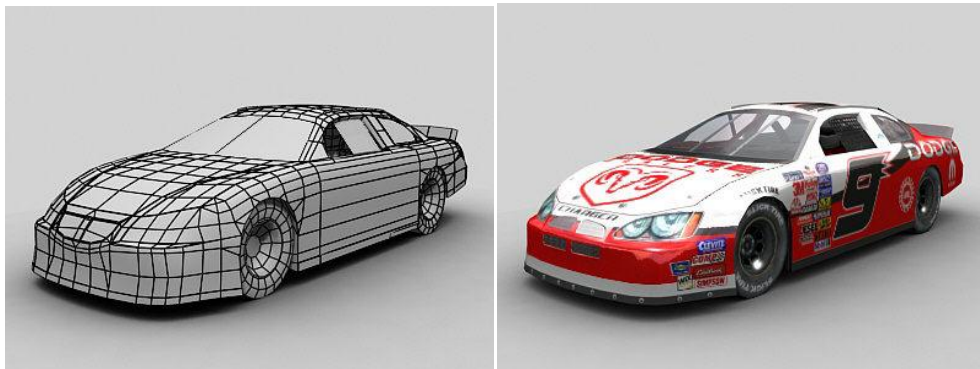
Figura 17 Modelo 3D de auto en bajo conteo poligonal
