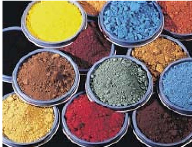
Fig. 4.5. Los pigmentos para el concreto se pueden conseguir prácticamente en cualquier color
