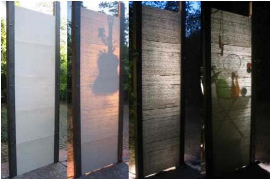
Fig. 5.1. Concreto translucido en diferentes intensidades de transparencia. Litracon, Arq. Aron Losonczi
