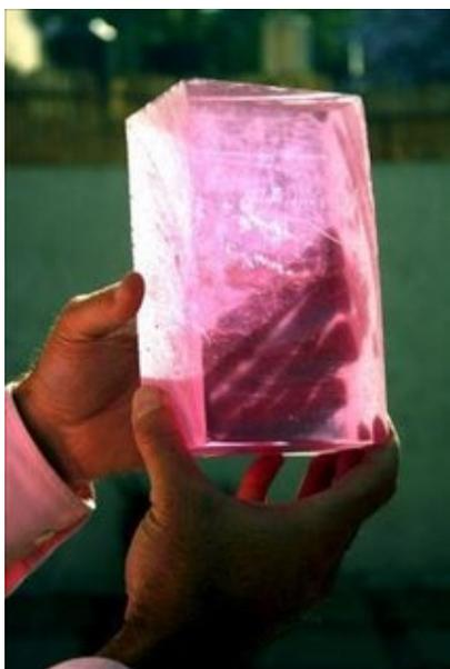
Fig. 5.8. Block de concreto translucido, Illum. México.
