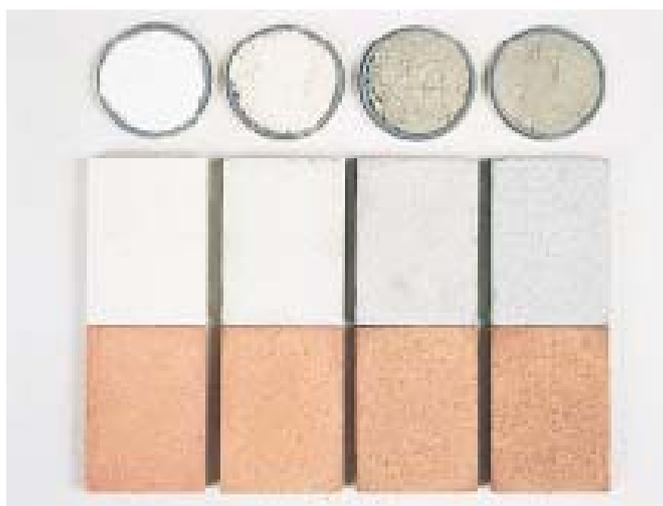
Fig. 4.4. Pequeñas muestras en donde se logra ver como la diferencia del color del cemento puede afectar el color del concreto.
