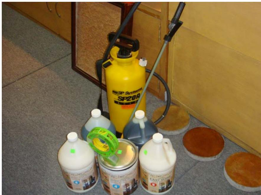
Fig. 4.8. Material y herramienta para los acabados oxidados
