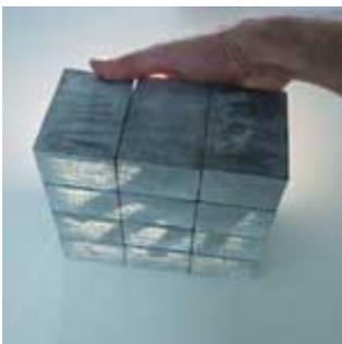
Fig. 5.3. Block hecho de concreto translucido LiTraCon.
