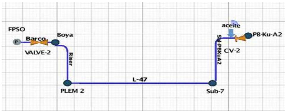
Figura 5.66.- Configuración de la línea 47 al FPSO en OLGA
