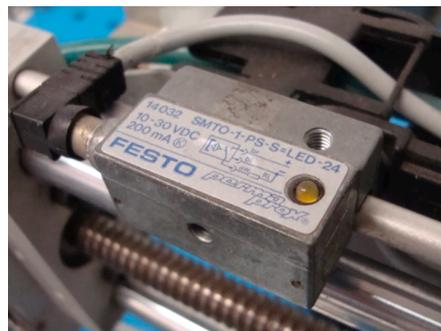
Figura 2.12: Sensor de proximidad magnético
