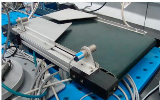
Figura 2.14: Banda transportadora
