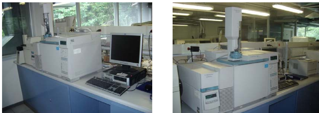
Figura 3.6 Equipo de cromatografía de gases acoplado a un detector selectivo de masas empleado en este trabajo
