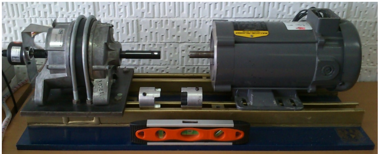
Figura 3.4: Estructura mecánica del banco de pruebas.
