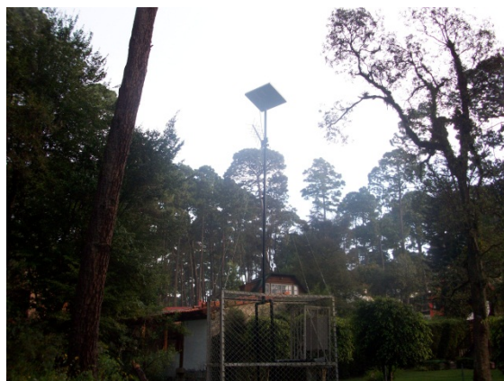
Estación hidrométrica automática
