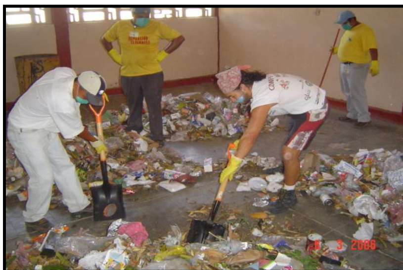
Figura 2 Método de cuarteo de residuos sólidos en Atoyac Fuente: Imagen tomada de (Gutiérrez, 2006)
