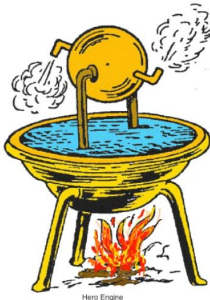
Fig. 1.2 Motor de Hero, 100A.C.
