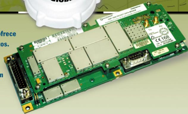
Diseñado para diversas aplicaciones, el Módem Satelital Globalstar GSP-1620 le ofrece conectividad bidireccional para el envío y recepción de datos desde lugares remotos. Para aplicaciones de Control Supervisorio y Adquisición de Datos (SCADA). El Módem Satelital Globalstar GSP-1620 le proporciona conectividad a Internet por Acceso Directo o por Acceso Telefónico a Redes. Ambas opciones proporcionan conexiones asíncronas que le permiten comunicarse con equipo en mar y tierra.
