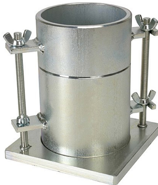
Fig 1.7. Molde para ensayo de compactación Proctor.
