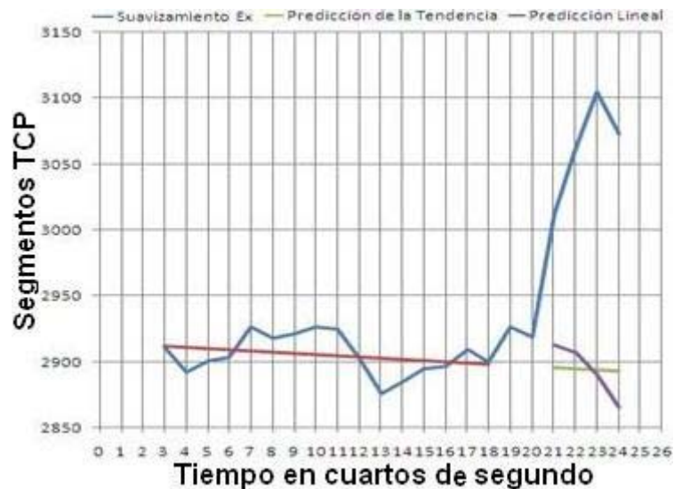
Figura 4.10: Predicción sobre TCP flooding
