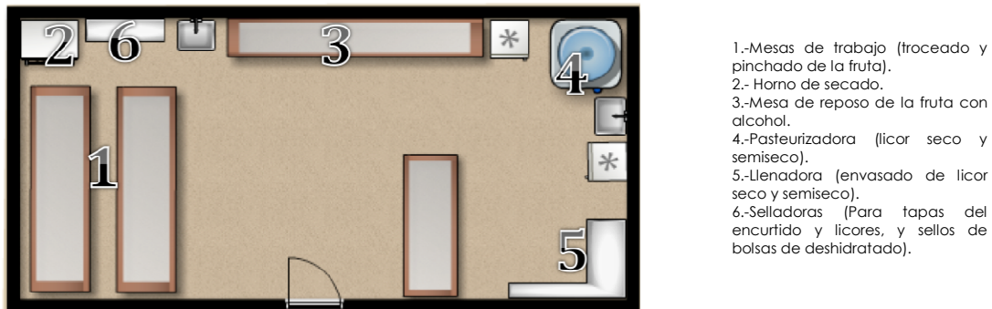
Figura 11. Distribución física del área de producción.
