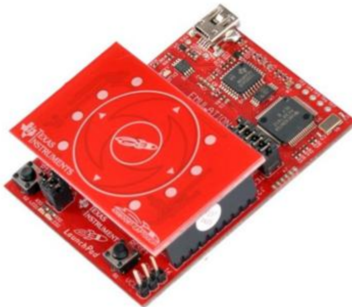
Figura 3.2 Capacitive Touch BoosterPack montado sobre Launchpad
