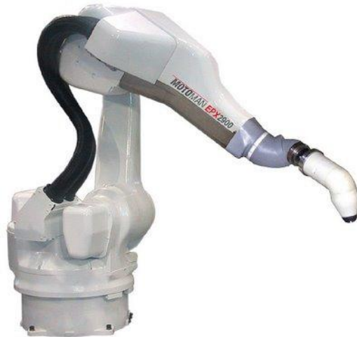
Figura 4.1 Robot de pintura de programación mediante guiado pasivo
