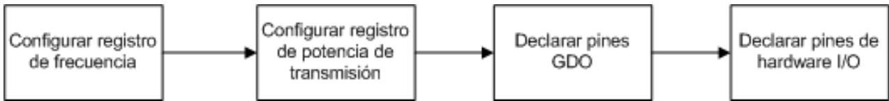
Figura 4.5 Algoritmo de programación de la librería del CC110L
