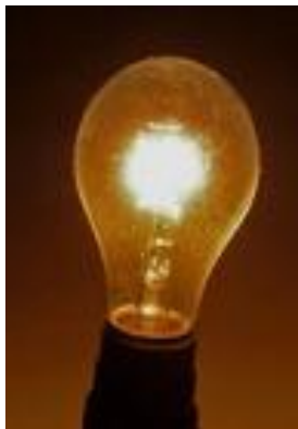
Lámpara incandescente con la tensión al inicio de la línea
