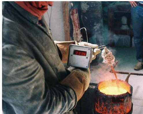
Figura F.5.- Medición de temperatura de fusión de un metal.
