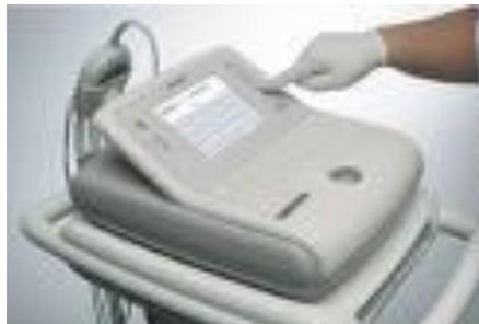
FIG. 2.9 ELECTROCARDÍOGRAFO EQUIPO MÉDICO TIPO B
