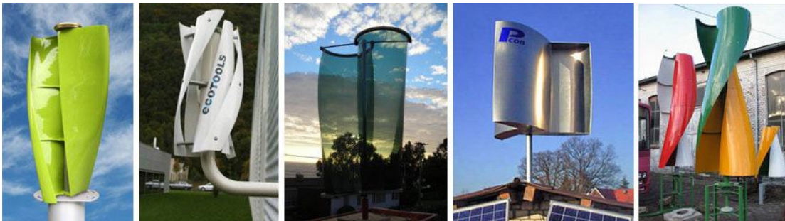
Figura 2.2. Aerogeneradores de eje vertical Savonius.
