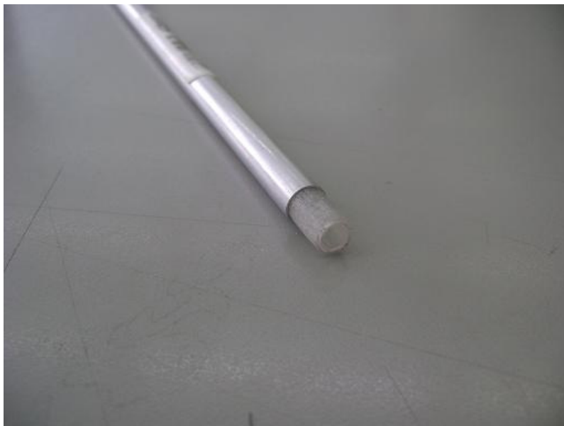
Figura 2.8. Tubo de plástico incrustado en otro de aluminio antes del corte.
