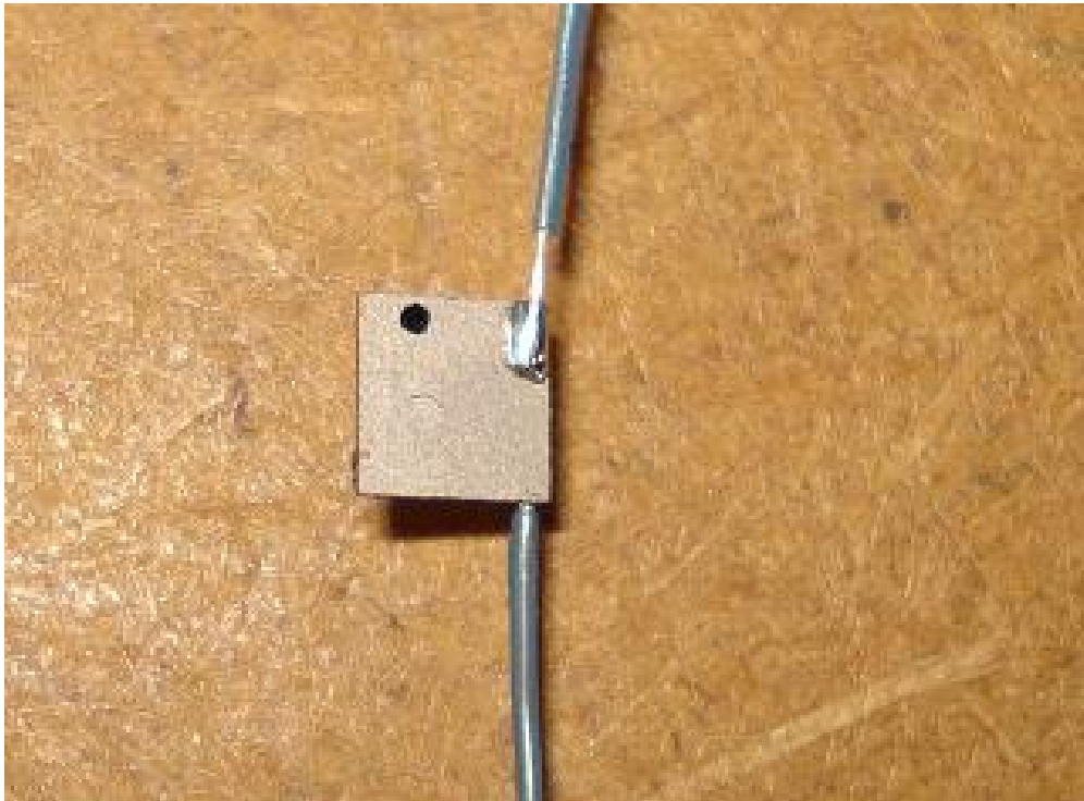
Figura 2.2. Cerámica Piezoeléctrica con alambres soldados en una orilla (Vista frontal)
