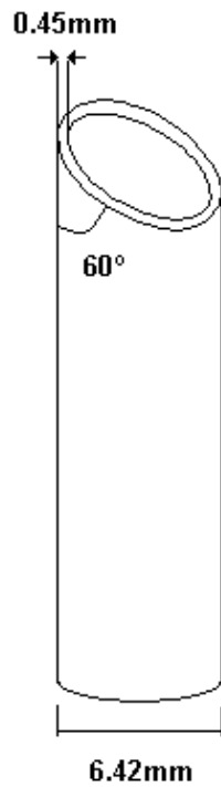
Figura 2.10. Dimensiones del diámetro, paredes y ángulo de los tubos utilizados para la carcasa (izquierda tubo de plástico y derecha tubo de aluminio).
