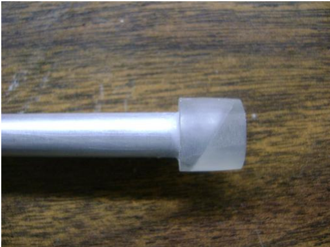
Figura 2.26. Capa de Rexolite pegada vista de perfil
