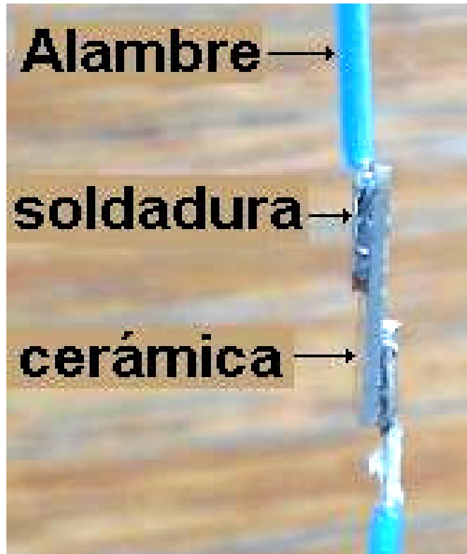
Figura 2.4. Cerámica Piezoeléctrica con alambres soldados en una orilla (Vista lateral)
