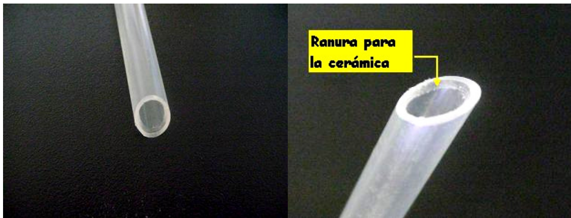
Figura 2.18. Tubo de plástico con la incisión para la cerámica
