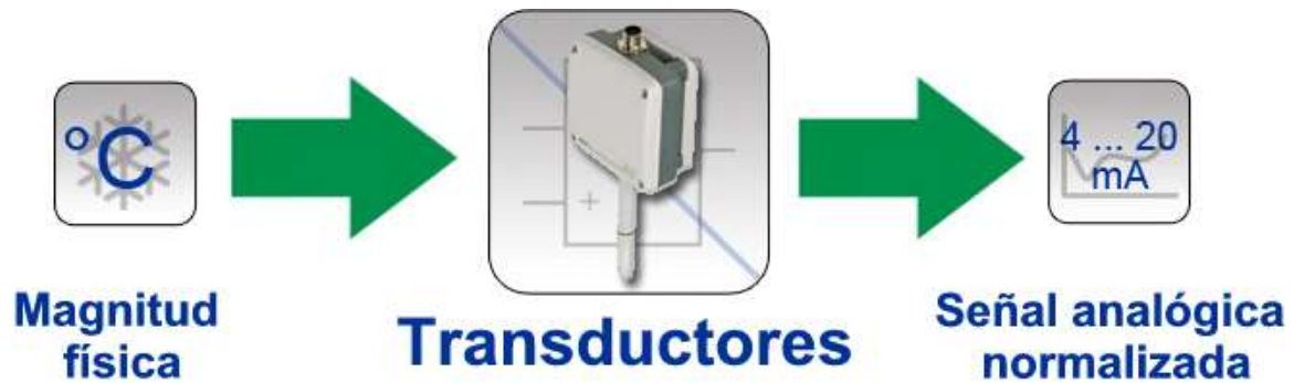
Figura 7.1.1 Diagrama de un transductor
