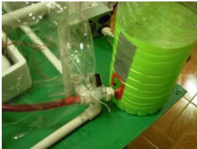
Figura 8.1.3 Tanque de agua y electroválvula
