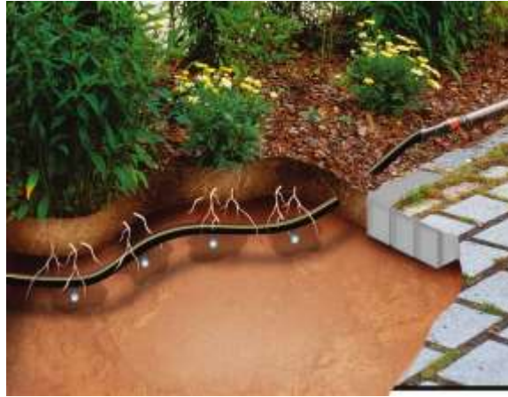
Figura 2.2.1) Sistema de riego subterráneo.
