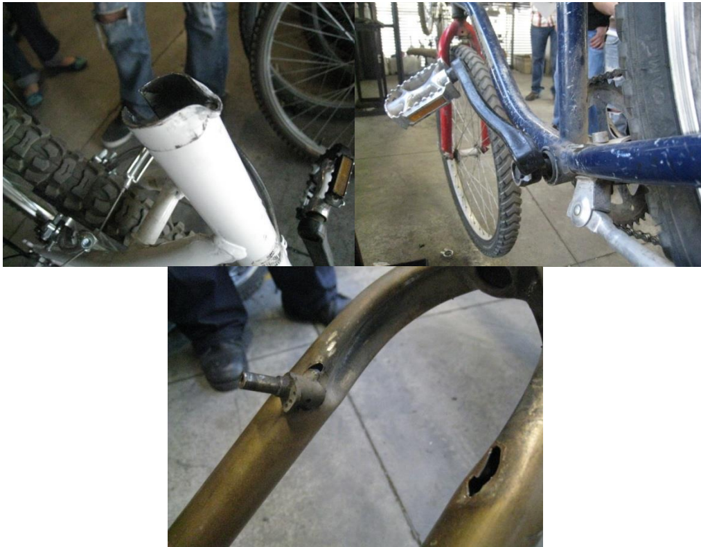
Fig. 5-5. Ejemplos de Fallas Encontradas en las Bicicletas BICIPUMA
