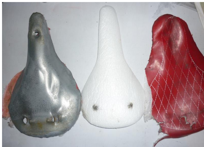
Fig. 6-1 Composición interna del asiento BICIPUMA
