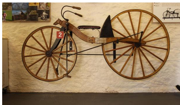
Fig. 4-2. Máquina de propulsión humana inventada por Kirkpatrick Macmillan
