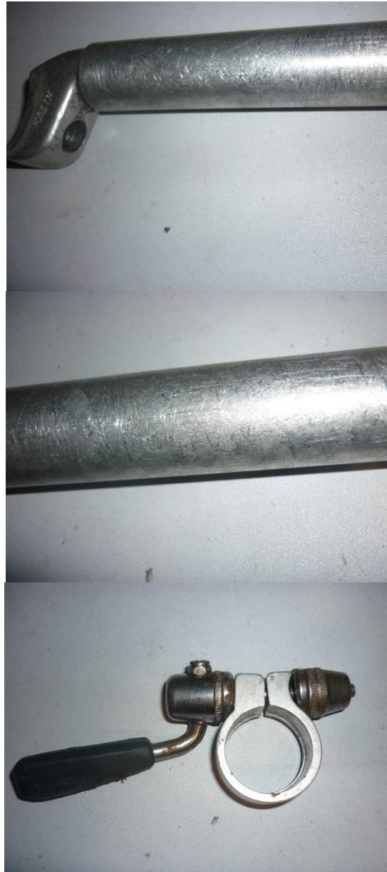
Fig. 6-2. Desgaste del tubo de Asiento y Abrazadera utilizada por BICIPUMA
