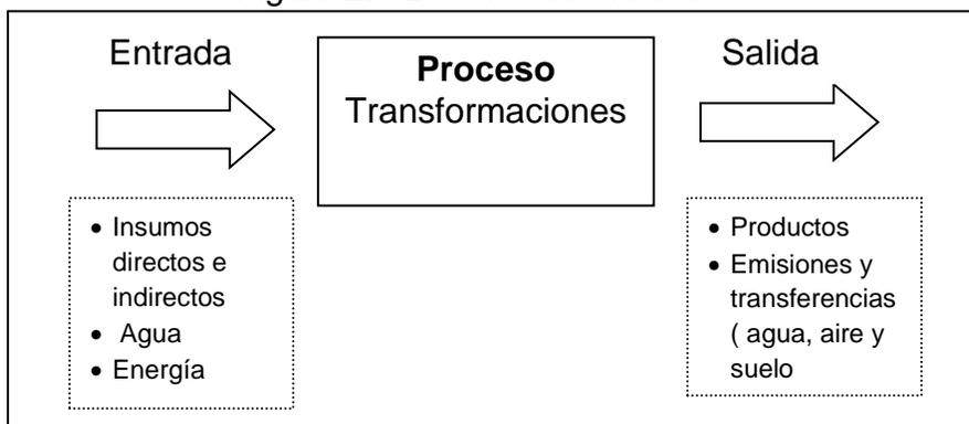
Para poder llevar al cabo un balance es indispensable contar con información relacionada con flujos de entrada y salida de materiales, composición química de productos y un conocimiento detallado del proceso. Si no se tiene toda la información y se realiza alguna suposición, se genera una incertidumbre en los cálculos que debe ser cuantificada.
