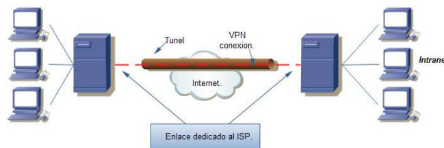
Figura 1.8: VPN LAN hacia LAN.
