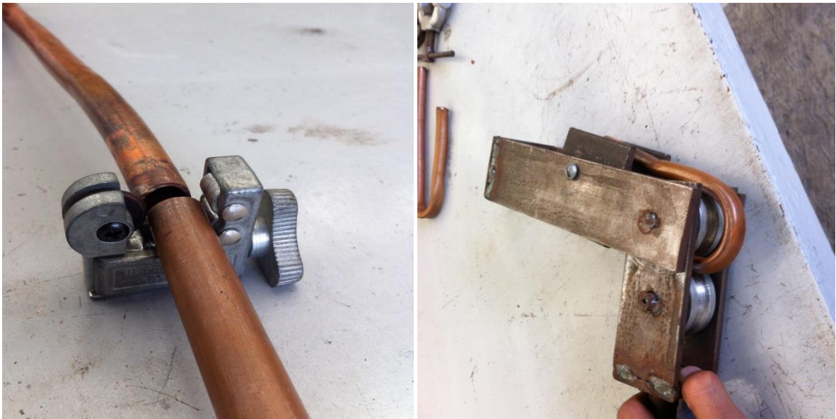
Figura 24. Proceso de corte y doblado de la tubería de cobre para ensamblar las pacas del evaporador y condensador
