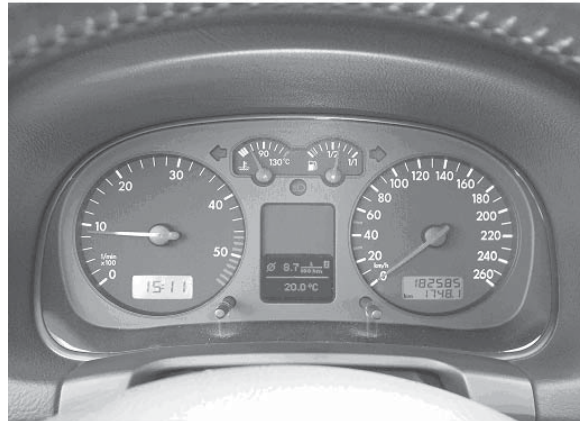
Figura 3.2: Panel de un automóvil: tacómetro y reloj (izquierda), velocímetro y kilometraje (derecha), ordenador de a bordo (centro abajo), temperatura del motor y estado del depósito de combustible (centro arriba).
