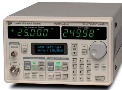
Figura 3.7: Controlador de Diodos Láser LDC501
