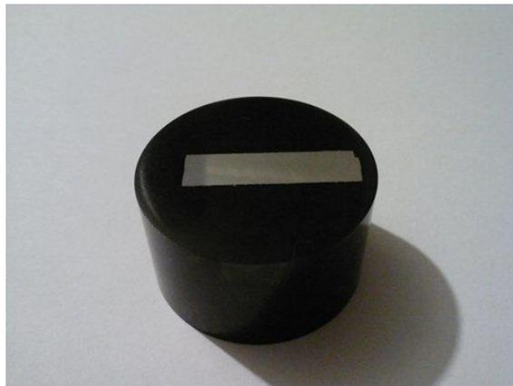
fig. 2.12 Muestra encapsulada en baquelita y pulida hasta acabado espejo.
