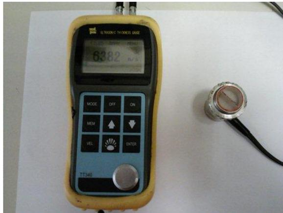
Fig. 2.8. Equipo que se utilizó para la medición de espesores por ultrasonido.
