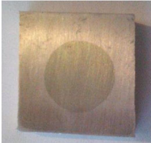
Fig.3.3 fotografía en la cual se muestran los resultados del proceso de anodizado a 4 V y 100mA a 1 A, en el cual ya no se presentan fallas superficiales.
