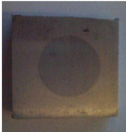
Fig.3.7. Capa anódica con una tonalidad acentuada y tintes morados, se obtuvo a 60 min, 5% en concentración de  $H_2SO_4$ , 4V y 1A.
