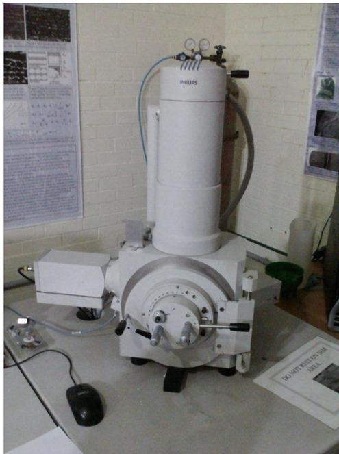
Fig.2.14. Microscopio Electrónico de Barrido marca Philips XL 20 empleado para la medición del espesor de la capa de anodizado.
