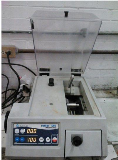
Fig.2.10. Cortadora de precisión que se utilizó para seccionar las muestras anodizadas.
