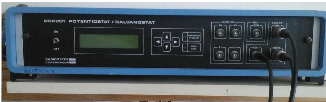
Fig. 2.3. Potencio-galvanostato utilizado para el proceso de anodizado.
