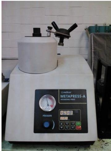
fig.2.11. Equipo encapsulador de alta presión.
