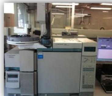
**Figura 4.29 Cromatografía de Gases HP6890**
