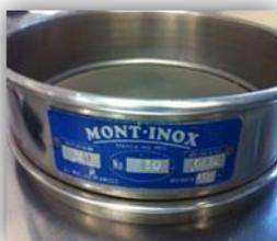
**Figura 4.25 Molido y Tamizado Malla no.30**
