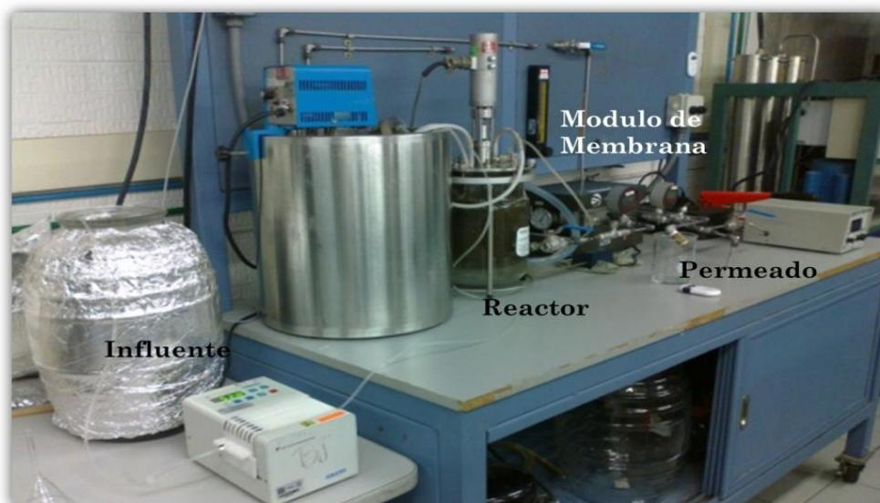
Figura 4.14 Operación del sistema sMBRs a nivel laboratorio.
