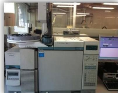
**Figura 4.23 Cromatografía de Gases HP6890**
