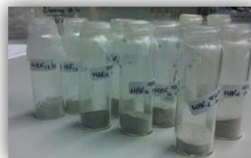
**Figura 4.26 Adición de Tierra de Diatomeas y Arena de Silica seca**
