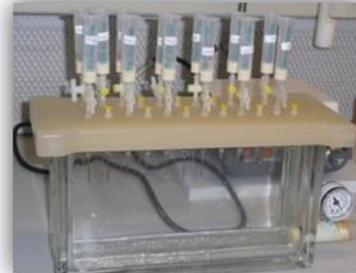
**Figura 4.20 Filtración en Cartucho Oasis**
