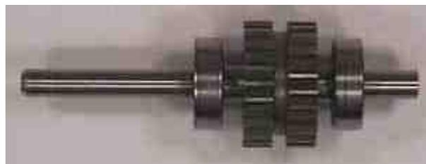
Figura 4.14 Rotor de un motor a pasos
