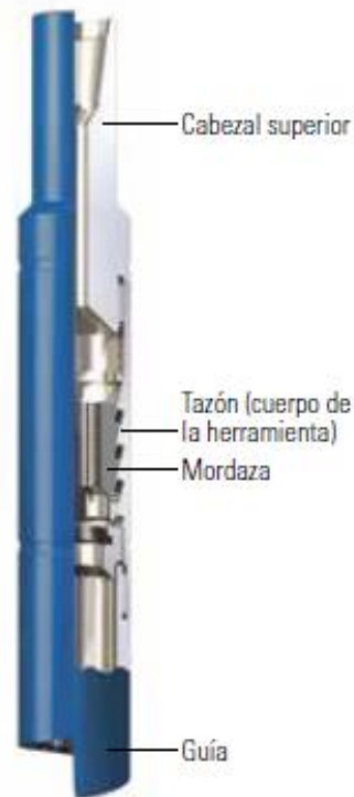
Figura 4.2. Pescante de agarre exterior
