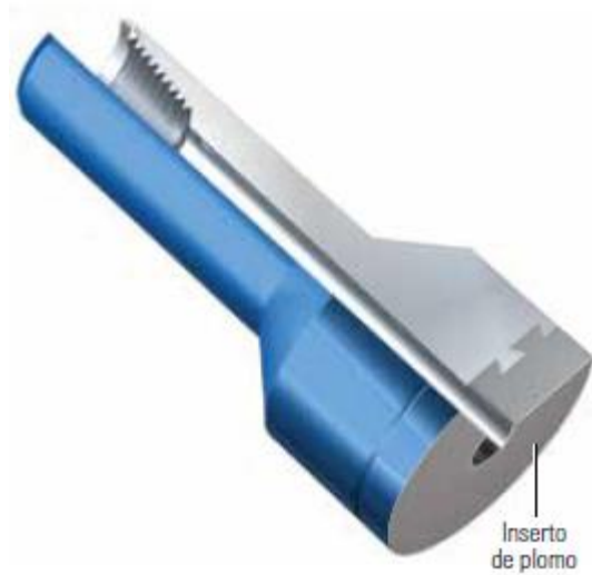
Figura 2.1. Bloque de impresión. Si existe incertidumbre acerca de qué tipo de objeto debe ser recuperado, el operador puede correr primero un bloque de impresión en el pozo.
