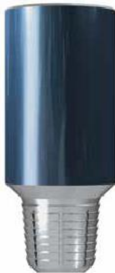
Figura 2.13. Terraja de pesca, se utilizan para ser enroscadas en una unión hembra de tubería cuando se recupera una pieza de pesca tubular que no puede rotar
