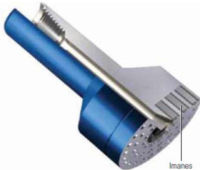
Figura 2.3. Imanes de recuperación. Este tipo de imán se utiliza para recuperar pequeños trozos de material ferroso dentro del pozo.
