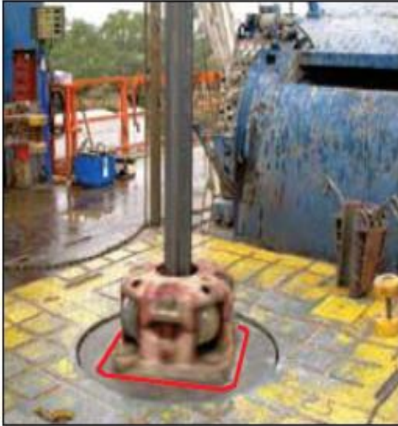
Figura 1.1. Buje principal o maestro se encuentra inmediatamente en el piso de perforación y cualquier elemento que pasa a través del tazón puede convertirse en una pieza de pesca.
