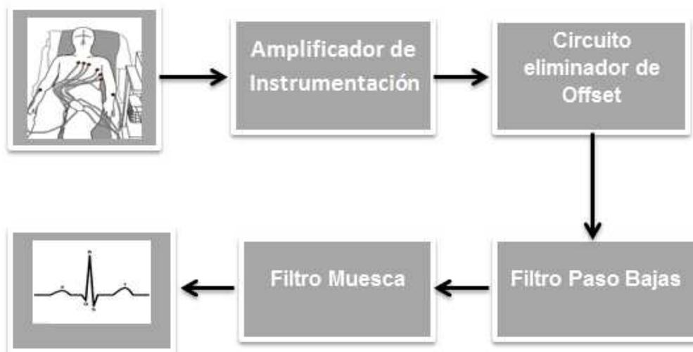
Figura 4.16 Diagrama de bloques del ASEC
