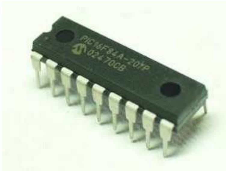
Figura 4.42 Microcontrolador PIC16F84A
