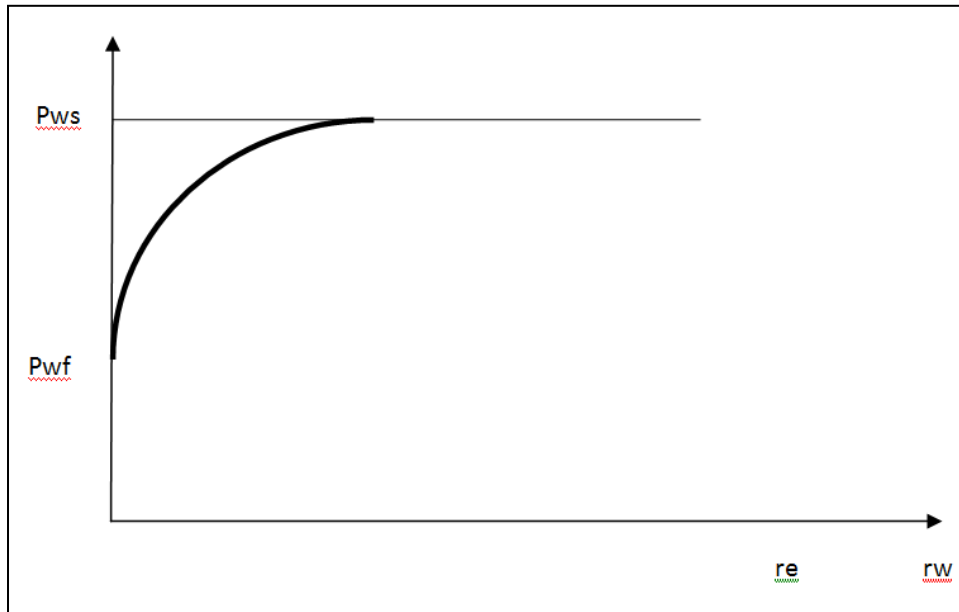
Fig. 2.4. Caída de Presión en la vecindad del pozo
